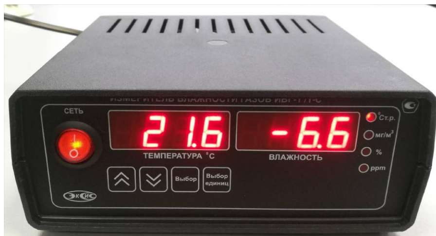
Рисунок 10 - Общий вид модификации ИВГ-1 /X, исполнение ИВГ-1 /1-С
