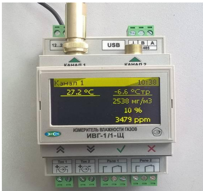
Рисунок 8 - Общий вид модификации ИВГ-1 /X, исполнение ИВГ-1 /1-Щ-Д
