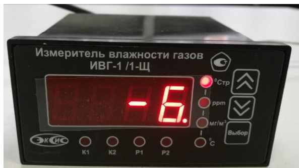
Рисунок 7 - Общий вид модификации ИВГ-1 /X, исполнение ИВГ-1 /1-Щ
