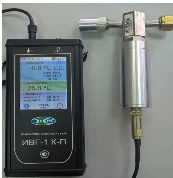
Рисунок 6 - Общий вид модификации ИВГ-1 К-П, исполнение ИВГ-1 К-П-Т
